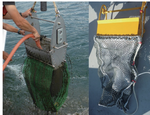
下田(左)と三崎(右)で使用しているドレッジ
